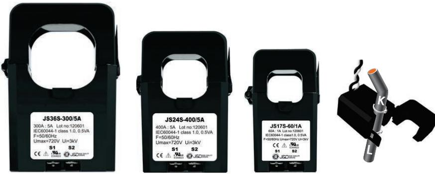
Diese Klappkernwandler liefern ausgehend von den erfassten Eingangsnennströmen jeweils einen sekundären Ausgangsstrom von 5A. Sie sind für Stromzähler und Leistungsmesser in Stromverteilungen, Bedienpulten, Schaltgeräten und anderen Einrichtungen einsetzbar. Durch Ihren Klappmechanismus können Sie auf Stromleitungen aufgesetzt werden, ohne dass diese unterbrochen werden müssen. Der eingebaute ausgangsseitige Überspannungsschutz ermöglicht eine sichere Montage.
